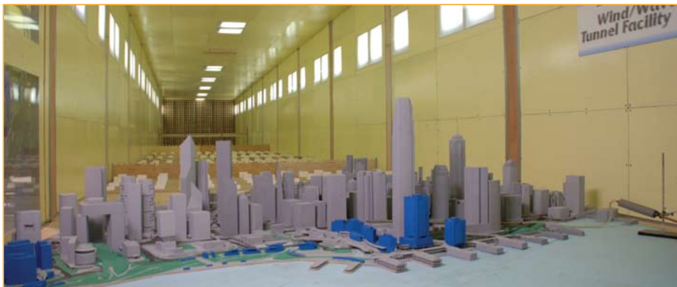
空氣流通評估風洞測試
