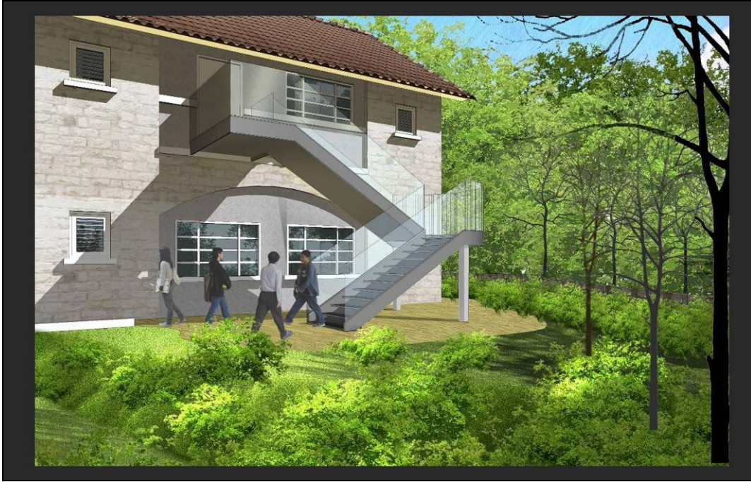
插圖 23：高級職員宿舍 – 集成照相顯示改造後東立面新加走火樓梯
