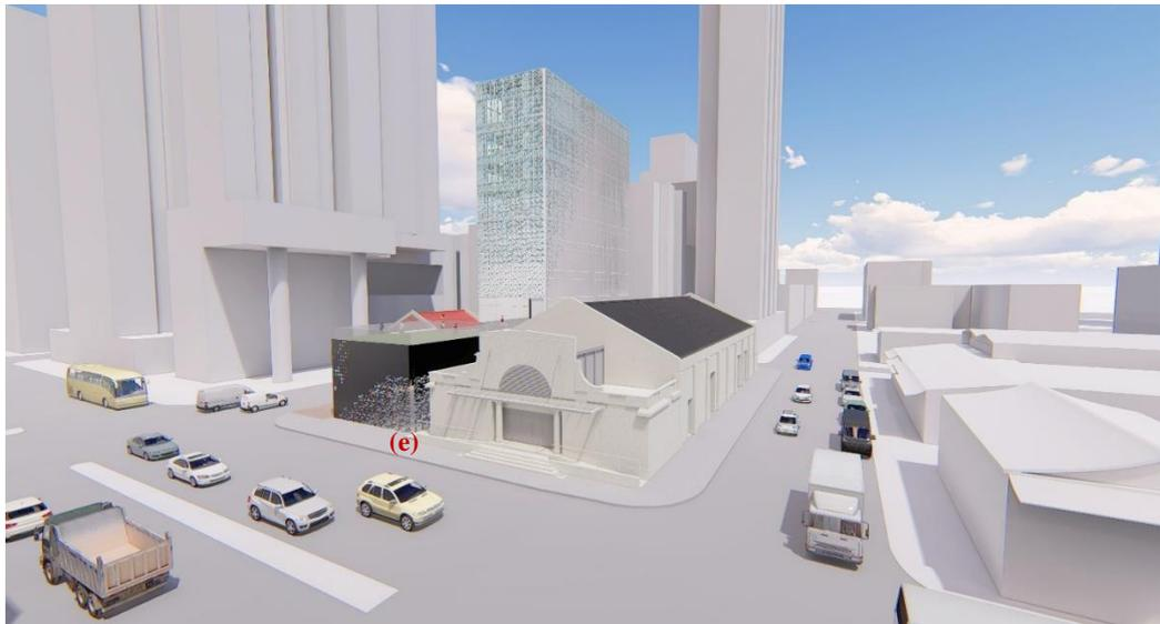
圖四及五 視點為窩打老道之構思圖：(a) 把擬建低座的外牆往後縮約 1.1 米；(d) 減少擬建低座的樓宇體積，並將其高度降低 0.7 米，讓市民更好地欣賞油麻地戲院的斜屋頂及其特色元素；(e) 運用不同透明度的外牆玻璃，增加油麻地戲院的能見度。
