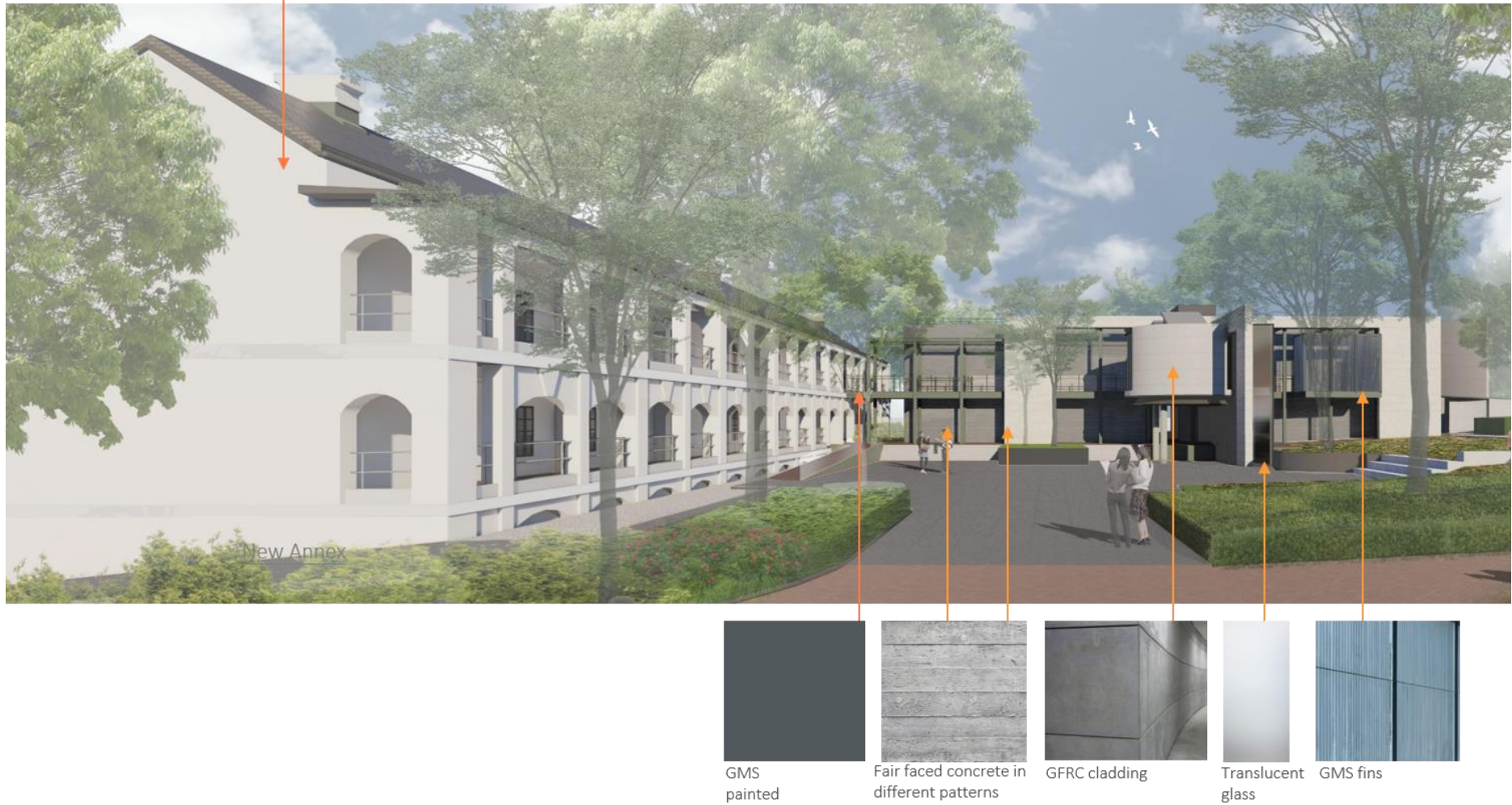
圖 14. 擬議的第58座和新附屬建築的裝修材料
