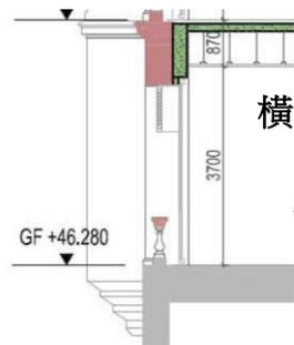
橫斷面顯示地下外牆加固結構
